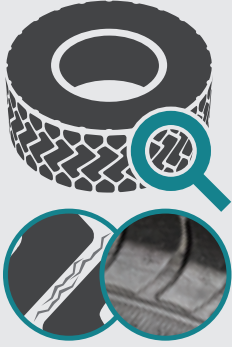
Lastik dişi arasında çatlama
