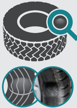
Abultamiento en los flancos del neumático
