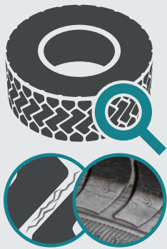
Praskliny mezi drážkami dezénu
