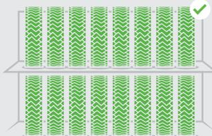
Montierte Reifen aufrecht lagern, frei von jeglicher Spannung. Es sollte ein Lagerumschlagsystem angewendet werden
