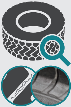
Crăpătură pe banda de rulare
